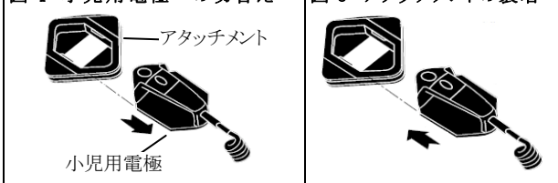
図4 小児用電極への切替え
